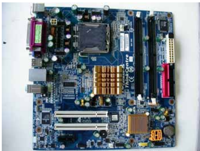
图 A.1 典型电路板组件图
